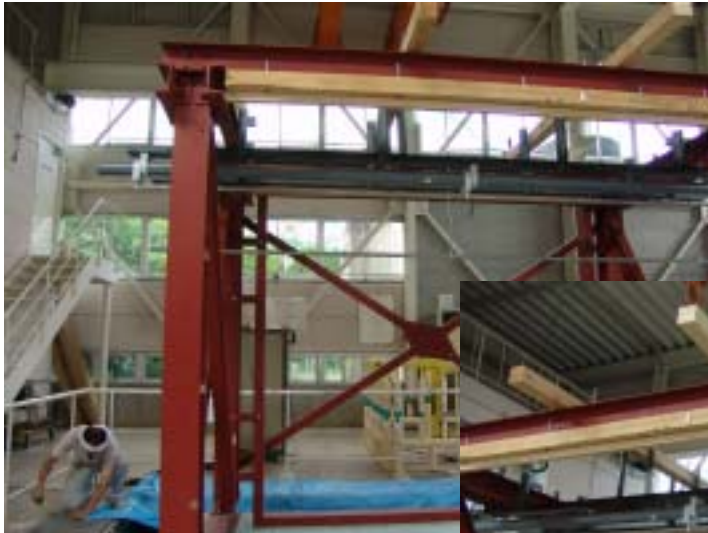
フレームへの「梁1、梁2」の取付状態
